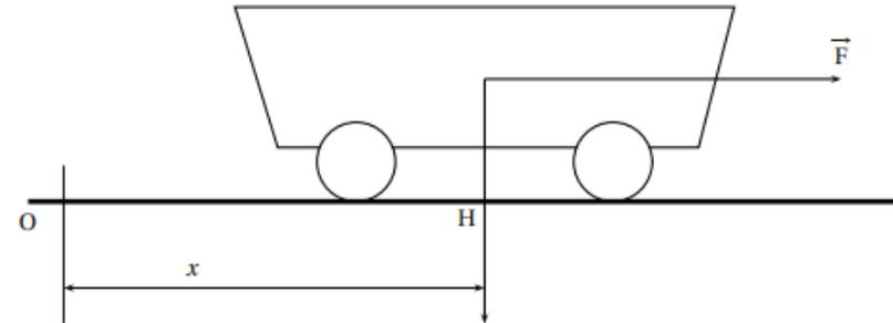
Un chariot de masse 200 kg se déplace sur une voie rectiligne et horizontale. Il est soumis à une force d'entraînement constante  $\vec{F}$  de valeur 50 N. Les forces de frottement sont proportionnelles à la vitesse et de sens contraire ; le coefficient de proportionnalité a pour valeur absolue  $25 \text{ N.m}^{-1} \cdot \text{s}$ .
