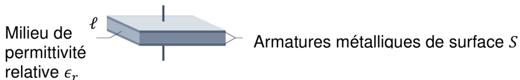
Figure 2 : Représentation schématique d'un condensateur plan
